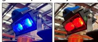
Zmienia się z ciągłego NIEBIESKIEGO na migający CZERWONY, gdy zostanie wykryty pieszy.
