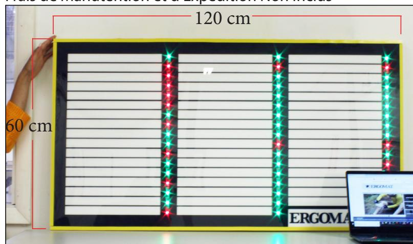
Tableau LED (DEL) pour Système d'Approvisionnement, Récepteur, et Alimentation 10 Amp
