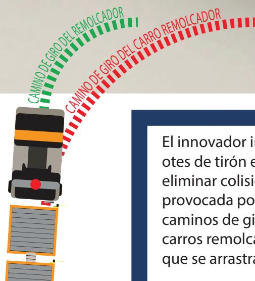
El innovador interruptor de bigotes de tirón está diseñado para eliminar colisiones provocada por los diferentes caminos de giro del tirón y los carros remolcadores que se arrastran.
